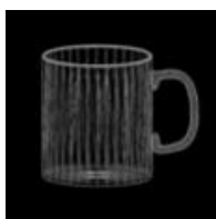
1.1: 三维打印可使用标准格式输出的CAD文件输出文件是一种包围着一定三维容积的网格
