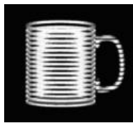
1.2: 3D打印机软件将三维模型切片成数百个数字化横截面，每个横截面对应于所要打印模型的一个层
